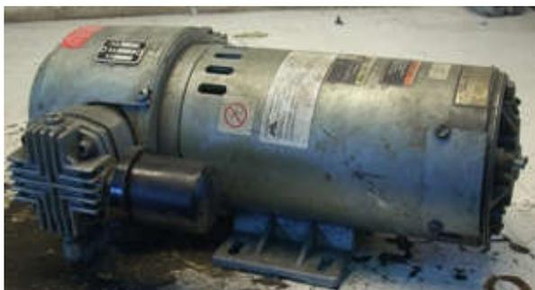
Compressore GAST Innalzamento Pantografo
