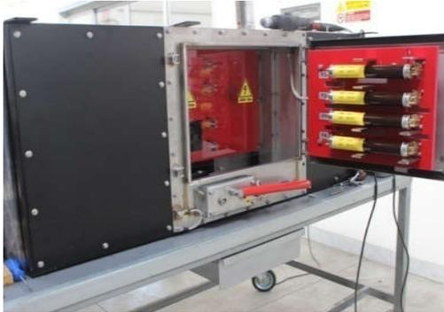
Casse A.T. per impianti di riscaldamento per carrozze MD
